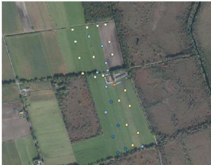
Figuur 3.2 Deelgebied 1 Aa en Maas, punten geven verschil tussen meetwaarden en ANH-filter waarden weer in m voor dataset 'final' (positieve waarde is hogere ANH-filter waarde dan meetwaarde).
