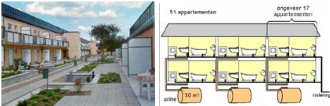
FIGUUR 41 DE WIJK PALSTERNACKAN MET OP DE VOORGROND ÉÉN VAN DE URINEOPSLAGSYSTEMEN (LINKS) EN DE OPZET VAN HET WATERSYSTEEM (RECHTS). PER 17 WONINGEN IS ER ÉÉN URINEOPSLAGVAT. (JOHANSSON)
