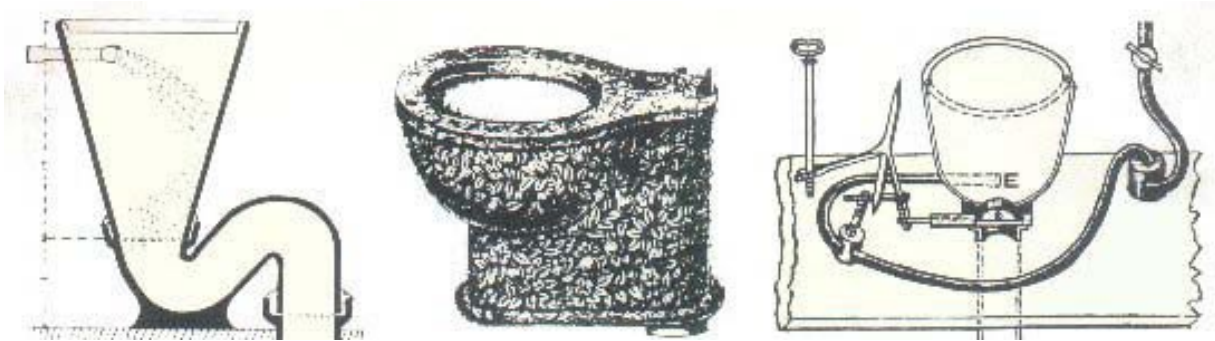
FIGUUR 1 TOILETSYSTEMEN ZOALS ONTWERPEN DOOR LIERNUR VOOR TOEPASSING IN HET PNEUMATISCH RIOLERINGSTELSEL
