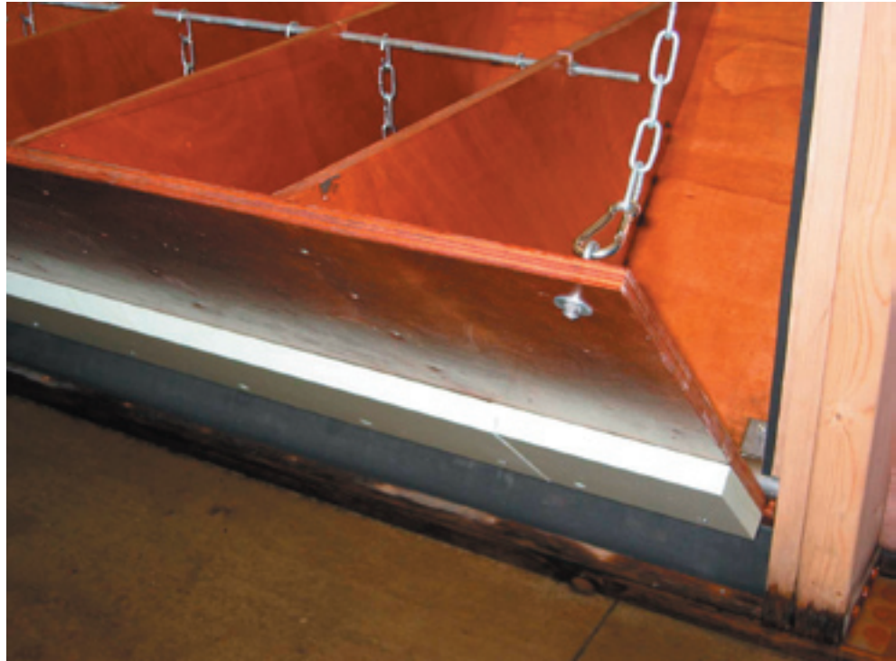
FIGUUR 3.6 DIMENSIONERING VAN DE AANPASSINGEN, DIE BESTAAN UIT EXTRA GEWICHT EN STYRODUR PLATEN DIE VOOR EXTRA DRIJFVERMOGEN ZORGEN
