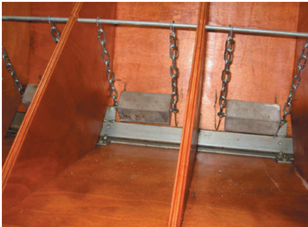
DETAILFOTO VAN SCHARNIEREND OPGEHANGEN GEWICHTEN. BIJ EEN KANTELHOEK VAN ONGEVEER 20° KOMEN DE KLEINERE, GOUDKLEURIGE KETTINGEN ONDER SPANNING TE STAAN. HIERDOOR KOMT HET GEWICHT NA HET DICHTKLAPPEN MINDER VER UIT HET MIDDEN TE LIGGEN WAARDOOR DE STUW MAKKELIJKER WEER OPENT
