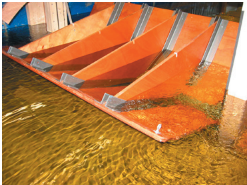
FOTO VAN HET MODEL. DOOR HET WIJZIGEN VAN HET AANTAL STALEN HOEKLIJNEN KUNNEN DE STUWKLEPPEN NAAR WENS WORDEN VERZWAARD
