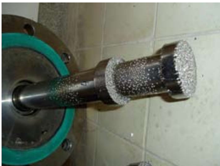
FIGUUR 8-1 SLIJTAGE SONOTRODE NA CIRCA 3.800 BEDRIJFSUREN, 29 JUNI 2005 BRON: D. JACOBS, WATERSCHAP AA EN MAAS
