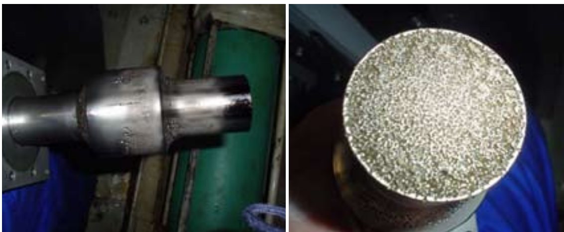
FIGUUR 5-5 SONOTRODE NUMMER 2: ZIJAANZICHT (LINKS) EN BOVENAANZICHT (RECHTS), OKTOBER 2006 NA EEN BEDRIJFSTIJD VAN CIRCA 3000 UUR. BRON: WATERSCHAP BRABANTSE DELTA
