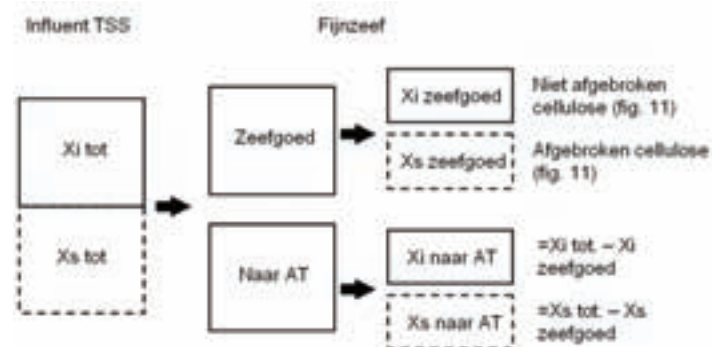
AFBEELDING 41 SCHEMATISCHE WEERGAVE VAN DE BEREKENING VAN X_i EN X_s VERWIJDERING VAN EEN FIJNZEEF
