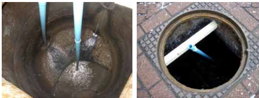
FIGUUR B2.2 MEETOPSTELLING MET MINI-DIVERS IN PEILBUIZEN
