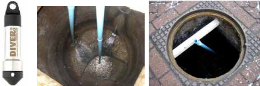
FIGUUR 3.3 MINI-DIVER (LINKS (BRON: SCHLUMBERGER)) EN MEETOPSTELLING (MIDDEN EN RECHTS)
