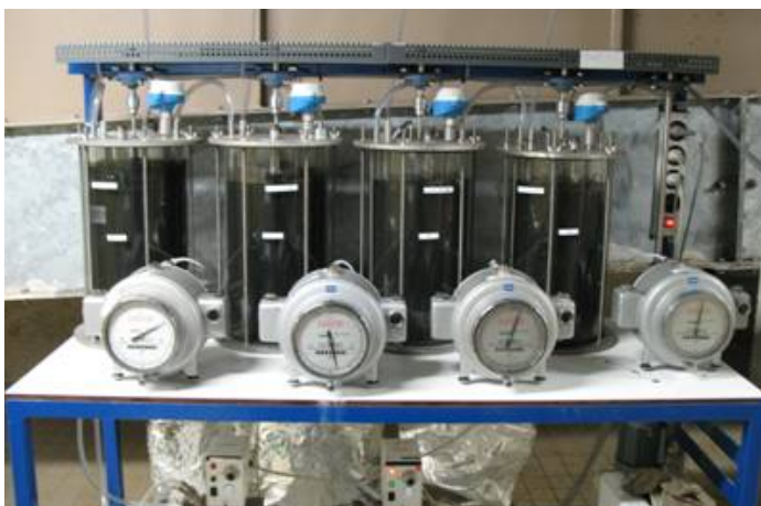
AFBEELDING 10 OVERZICHT VAN DE SLIBGISTINGSINSTALLATIES MET GASKLOKKEN
