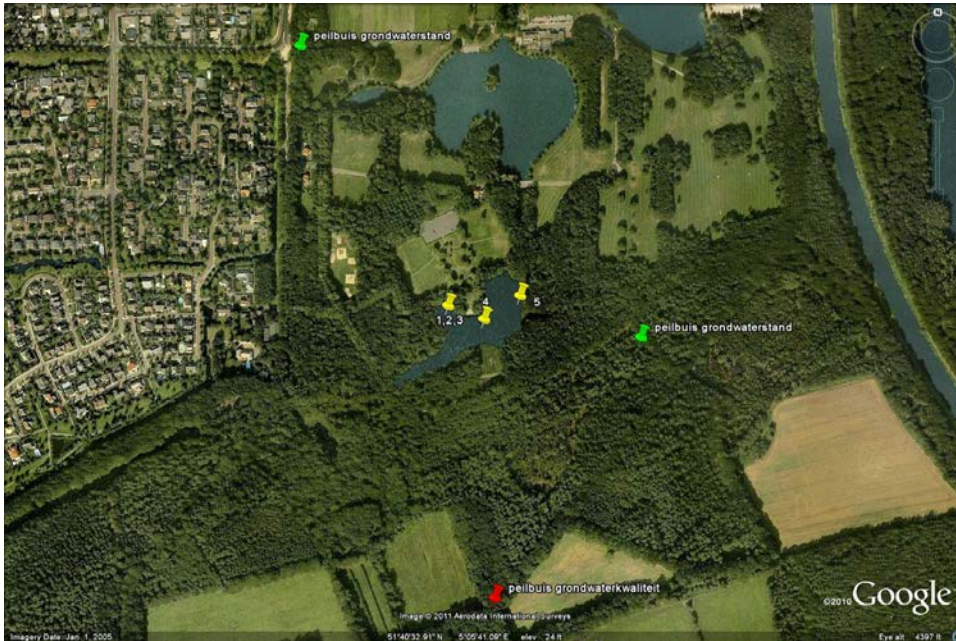
Figuur 2 Luchtfoto van het Hoefsven. In het midden aan de noordkant ligt het zwemstrandje. De gele markers zijn de veldwerklocaties van B-ware, de groene markers zijn de gebruikte peilbuizen voor grondwaterstanden en de rode marker is de dichtstbijzijnde peilbuis
