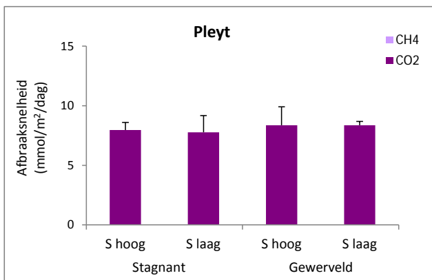
Figuur 3.85: De afbraaksnelheid in mmol C/m²/dag van de onderwaterbodems van de Pleyt onder invloed van twee oppervlaktewaterbehandelingen, gemeten in een stagnante en een gewervelde situatie.
