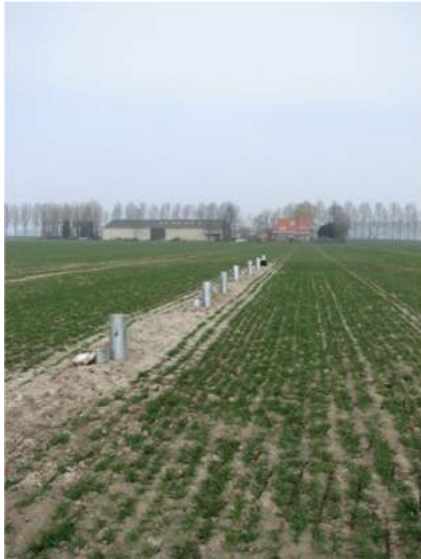
Figuur 137 Peilbuizen op het infiltratieproefperceel.
