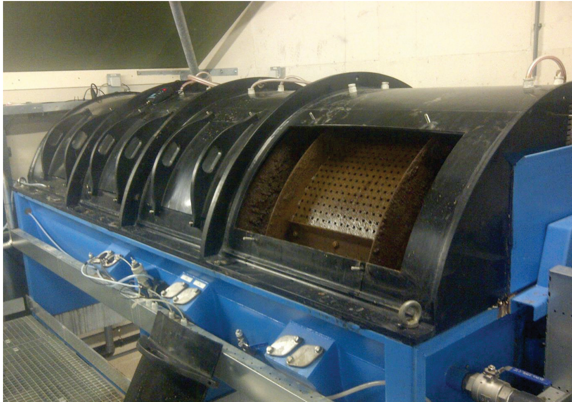
FIGUUR 6 BIOROTOR VOOR HET OLAND-PROCES.
