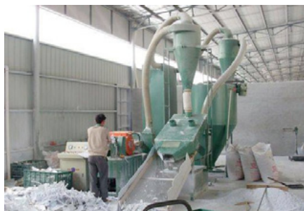
AFBEELDING 9 VEZELRECYCLING VAN PRODUCTIE-AFVAL LUIERPRODUCTIE (LA ROCHE-INSTALLATIE)
