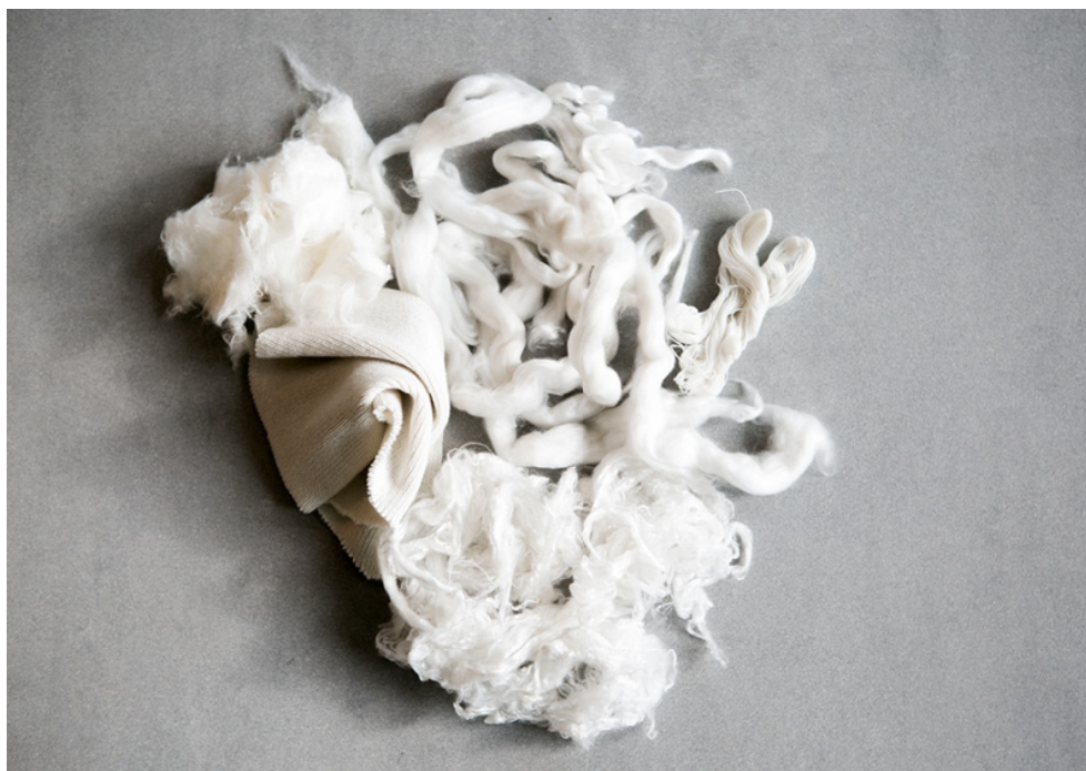
AFBEELDING9: UIT TEXTIELAFVAL GESPONNEN VEZELS (NATSPINNEN) (SAXION)
