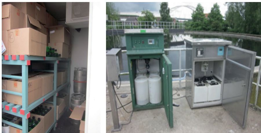
FIGUUR 10 INVRIEZEN VAN MONSTERS (L) EN DE MONSTERNAMEKASTEN VOOR DWA EN RWA (R)
