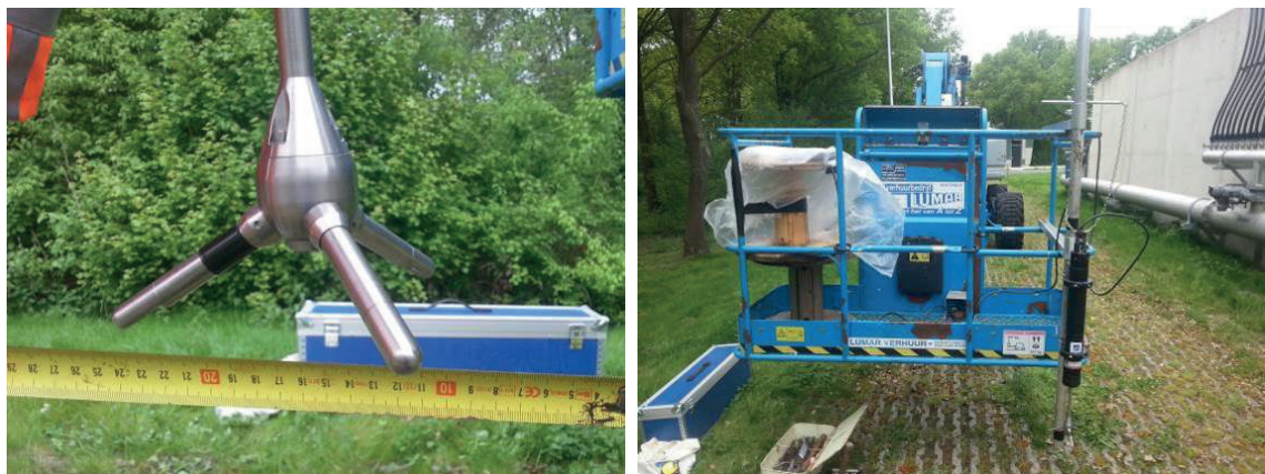
AFBEELDING 10 MEETOPSTELLING VAN DE 3D-SNELHEIDSMETINGEN
