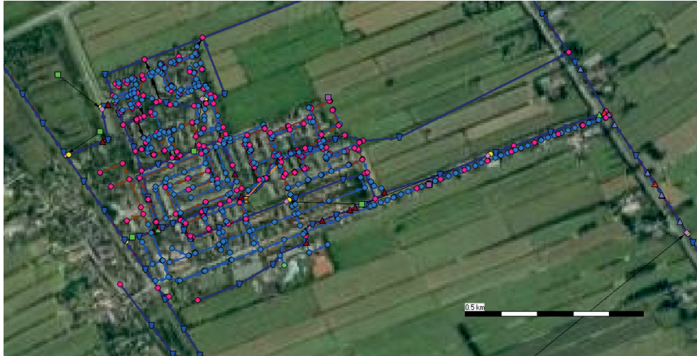
RIOOLSTELSEL VAN KOCKENGEN NA TOEVOEGING AAN DE POLDERSCHEMATISATIE IN SOBEK
