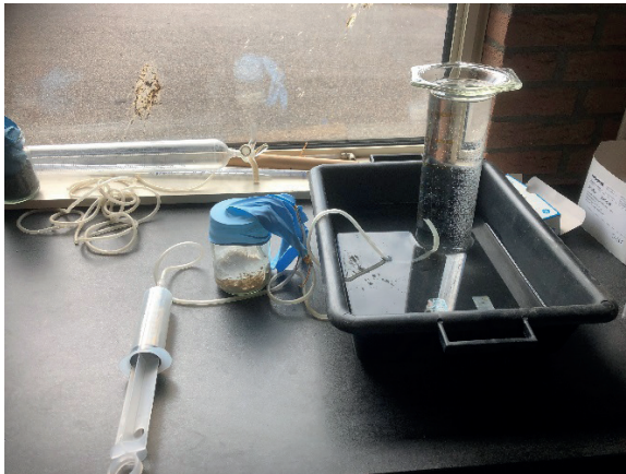
PH METING (PH 0,1); 44C (REACTIEWARMTE)
