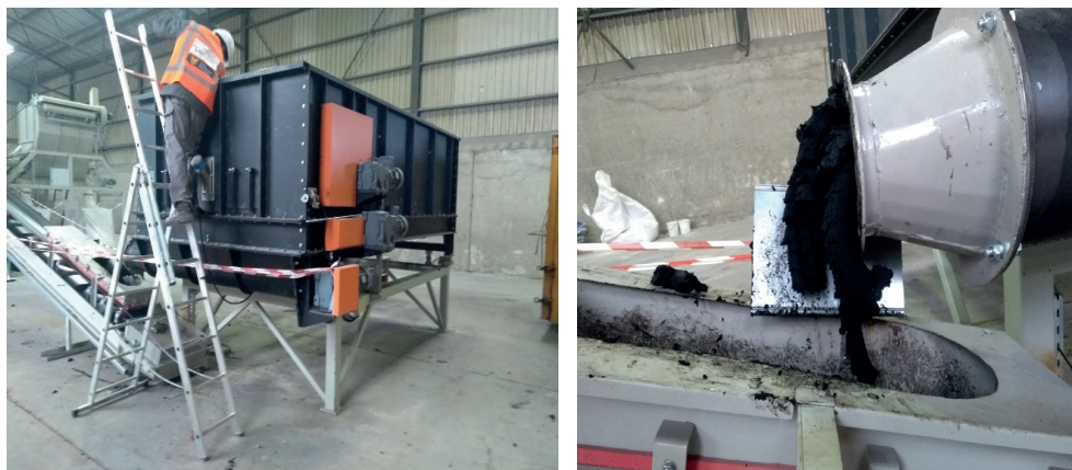
FIGUUR 3.2 TOEVOERBUFFER (LINKS) MET EXTRUDER (RECHTS)
