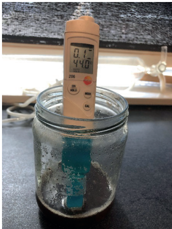
PH METING (PH 0,1); 44C (REACTIEWARMTE)
