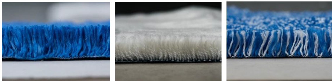
FIGUUR 2 VERSCHILLENDE TYPEN DOEK VOOR DOEFILTRATIE (BRON MECANA)
