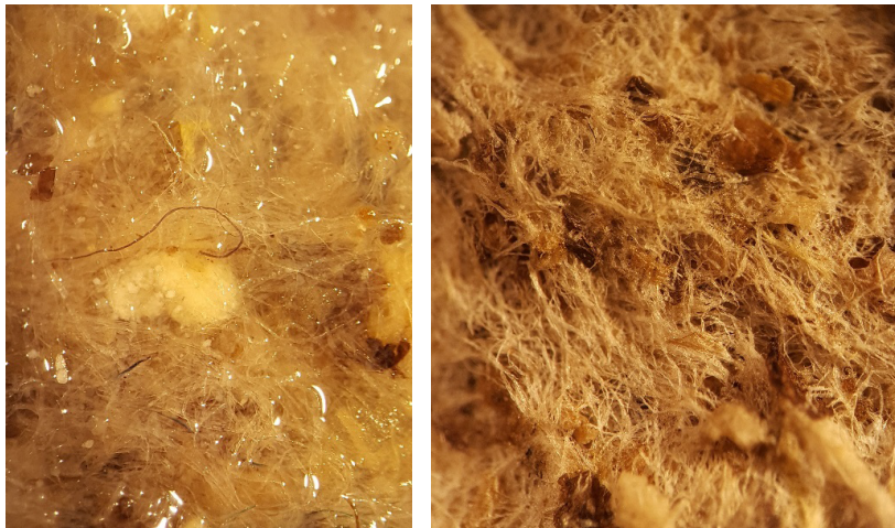
FIGUUR 5.3 MICROSCOPISCH BEELD; LINKS: GEDROOGD ZEEFGOED HANDZEEF (0,4MM); RECHTS: TOILETPAPIER
