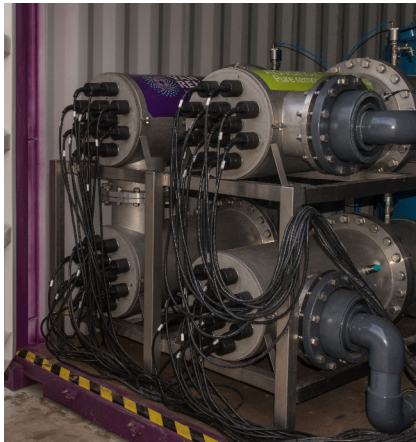
FIGUUR 3.7 FOTOS VAN DE UV-PILOT. OP DE FOTO LINKSBOVEN ZIJN DE 4 UV-REACTOREN TE ZIEN MET IEDER 12 UV-LAMPEN. OP DE FOTO RECHTSBOVEN IS AAN DE RECHTERZIJDE DE BLAUWE TANK TE ZIEN WAARIN HET KATALYSATORBED ZICH BEVINDT, EN IN HET MIDDEN DE ACHTERZIJDE VAN DE UV-REACTOREN. OP DE FOTO LINKSONDER EEN UV-LAMP EN OP DE FOTO RECHTSONDER IS HET BEDIENINGSPANEEL TE ZIEN
