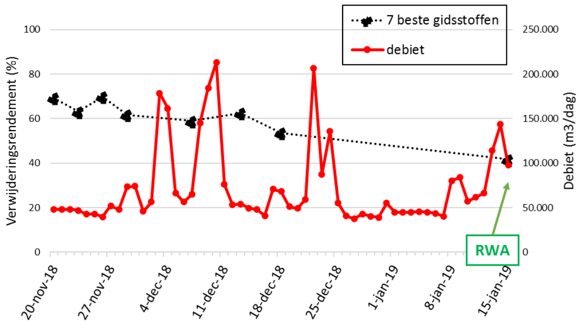
FIGUUR B 24.1 GEMIDDELD VERWIJDERINGSRENDEMENT VAN DE 7 BEST VERWIJDERDE GIDSSTOFFEN VAN DE 11 IN DE RWZI AARLE-RIXTEL PER BEMONSTERINGSDAG EN HET RWZI DEBIET TIJDENS DE VERGELIJKENDE TEST (20 NOVEMBER 2018 T/M 15 JANUARI 2019).
