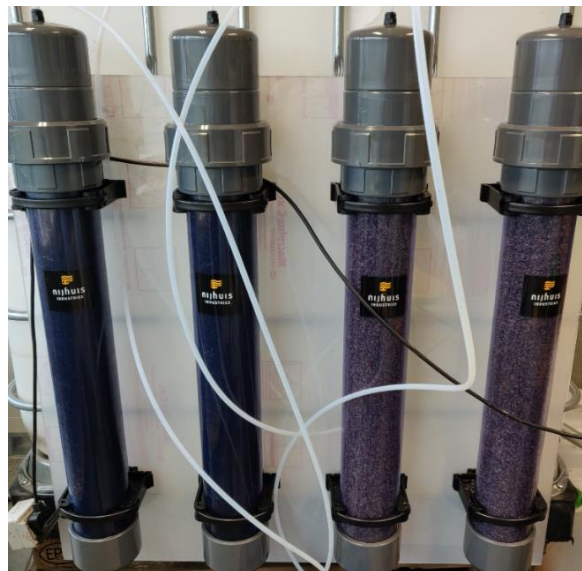
Figuur 2: Kolombord met filtratiemedium; Actief kool (2 linkse) en Biologisch actief zand (2 rechtse)
