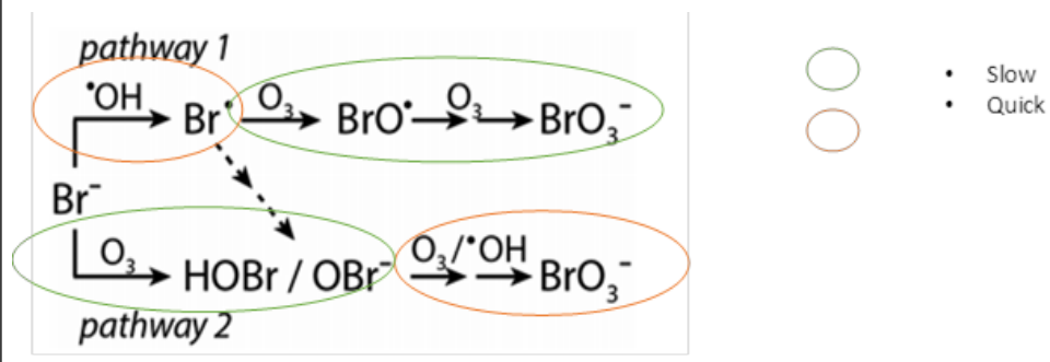
FIGUUR 5.7 SCHEMATISCHE WEERGAVE VAN DE REACTIEROUTES VAN BROMIDE NAAR BROMAAT
