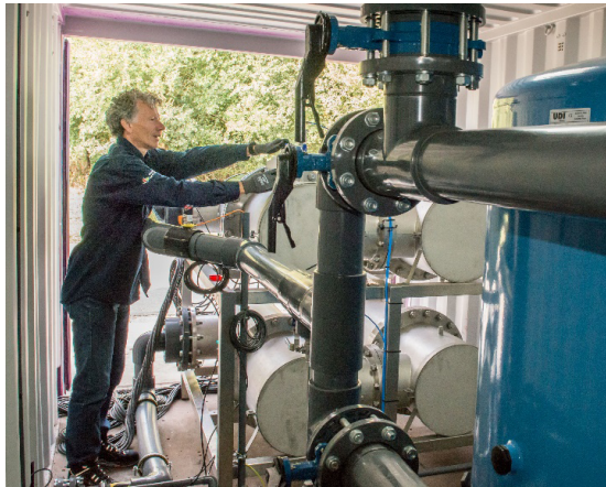
FIGUUR 3.7 FOTOS VAN DE UV-PILOT. OP DE FOTO LINKSBOVEN ZIJN DE 4 UV-REACTOREN TE ZIEN MET IEDER 12 UV-LAMPEN. OP DE FOTO RECHTSBOVEN IS AAN DE RECHTERZIJDE DE BLAUWE TANK TE ZIEN WAARIN HET KATALYSATORBED ZICH BEVINDT, EN IN HET MIDDEN DE ACHTERZIJDE VAN DE UV-REACTOREN. OP DE FOTO LINKSONDER EEN UV-LAMP EN OP DE FOTO RECHTSONDER IS HET BEDIENINGSPANEEL TE ZIEN
