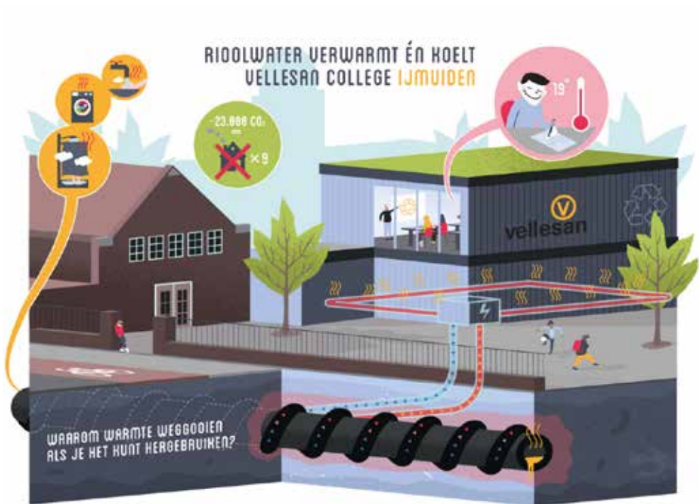
Figuur 4.3 Illustratie van het riothermiesysteem van het Vellesan College in IJmuiden, gemeente Velsen (Bron: Syntraal)
