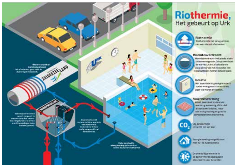
Figuur 4.7 Illustratie van de werking van het riothermiesysteem van zwembad 't Bun op Urk (Bron: Waterschap Zuiderzeeland en gemeente Urk)
